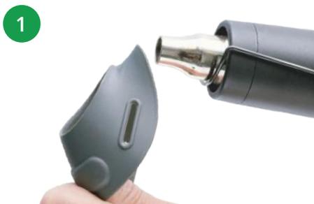
1 Use una pistola de calor puntual y caliente el borde de la férula solo hasta que el material esté brillante y ceda cuando lo empuje. No sobrecalentar
